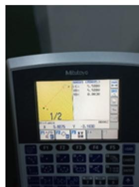
Gambar 3.4 *Setting* titik ukur dimensi roda gigi lurus      Gambar 3.5 Pengukuran dimensi roda gigi lurus
