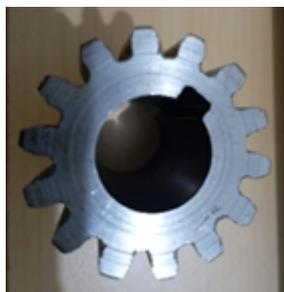
Gambar 3.2 Sampel roda gigi lurus
